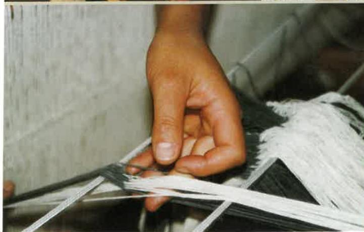
*Em cima, à esquerda: Artesã tecendo em tear de pedal; Em cima, à direita: Repasse dos fios de urdume no liço; Embaixo: Fios de urdume alternados em cruz para facilitar a identificação da seqüência correta.*
